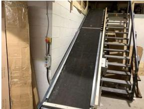
Convoyeur à tapis automatisé, 24" x 16'
