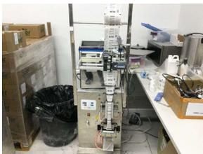
Machine de remplissage et de pesage des grains
